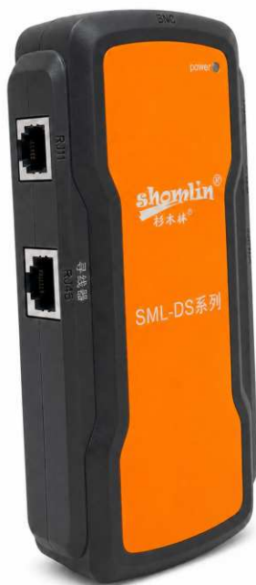
(a) 发射器 RJ11 与 RJ45 接口
