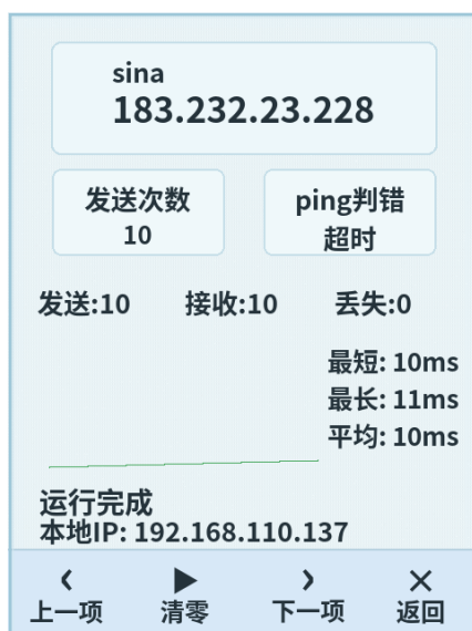
图 5-8 PING 测试详情界面（示例结果受网络环境影响）
