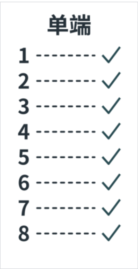
图 5-1 RJ45 单端测试正常界面示例：1~8 芯分别显示通过标记。
