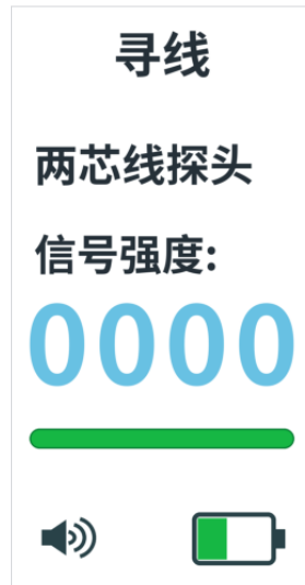
图 5-3 两芯线寻线界面示例：显示“两芯线探头”和相对信号强度。
