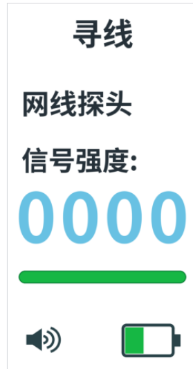
图 5-2 RJ45 网线寻线界面示例：显示“网线探头”和相对信号强度。
